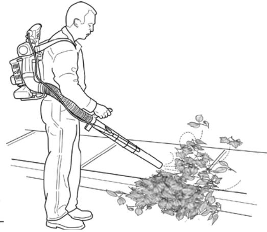
a) **Lärmbelastung** - Elektro-Laubbläser erreichen vom Erzeuger gemessene Spitzenwerte von 75-110 dBA, Benzin-Laubbläser 90-120 dBA, was Kreissägen oder Pressluftschlämmern nahe der menschlichen Schmerzgrenze von 120 dBA entspricht, für den Anwender professionellen Gehörschutz erfordern würde und den ungeschützten Anrainern rasch unerträglich wird.
